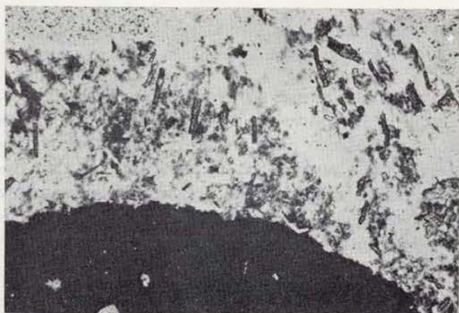
Foto núm. 14.—Adherencia rocosa en el borde de un nódulo aluvial formada por clorita, rutilo microacicular y pequeños prismas de cloritoide con disposición arbitraria ( \times 100 ); N//.
